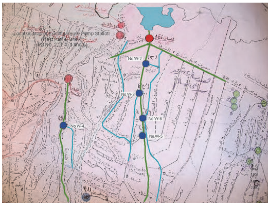
図 2 - 10 排水再利用ポンプ場の位置図 (一部)
