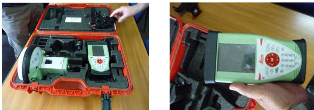
図 3-1 KCA の保有機材（GNSS のレシーバーとコントローラ）
