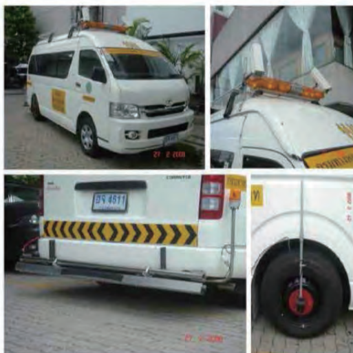
図 62 開発した路面性状調査車（Rosy Car）
