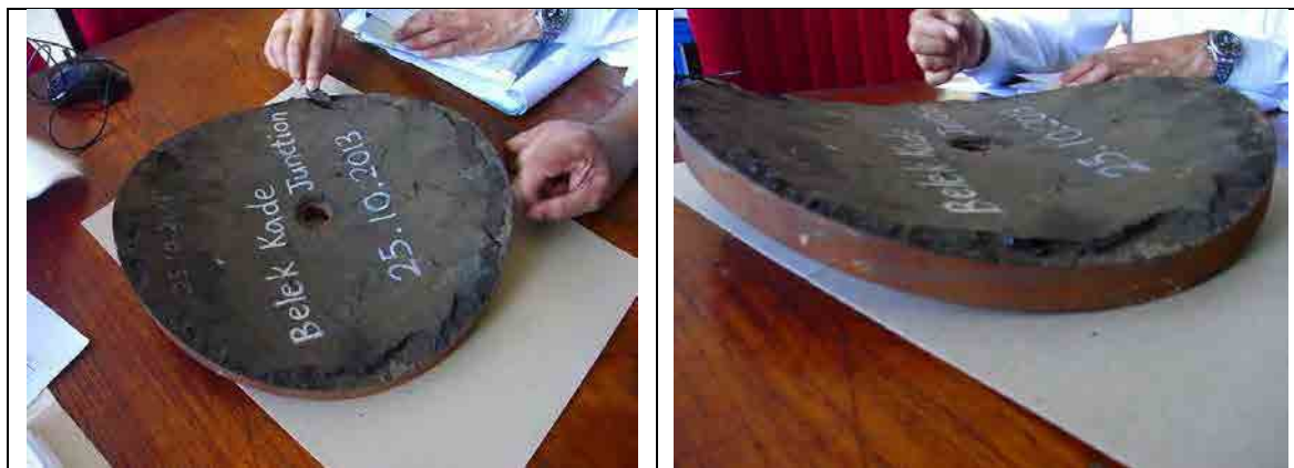
写真 5.2.1: 800 mm 普通鑄鉄管の内面のサンプル
