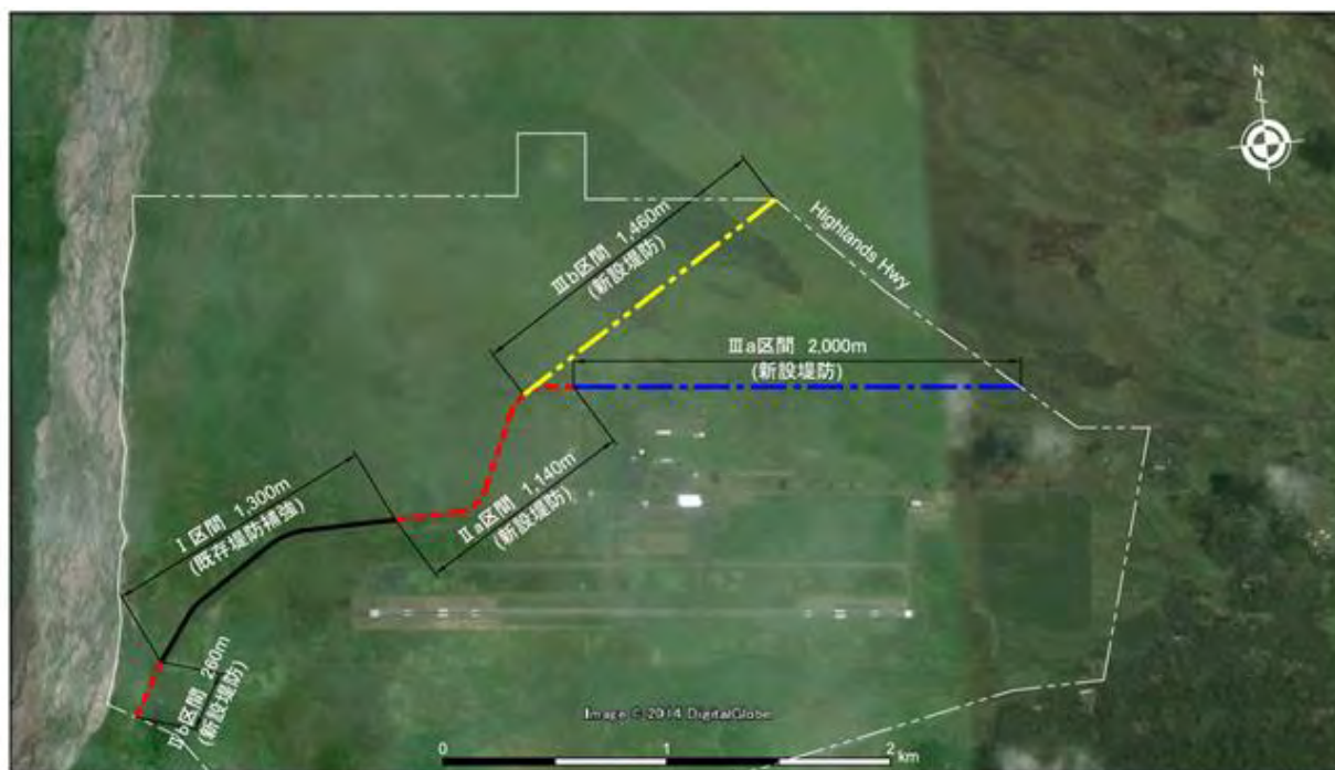
図 13.4-1 堤防補強工区の一例
