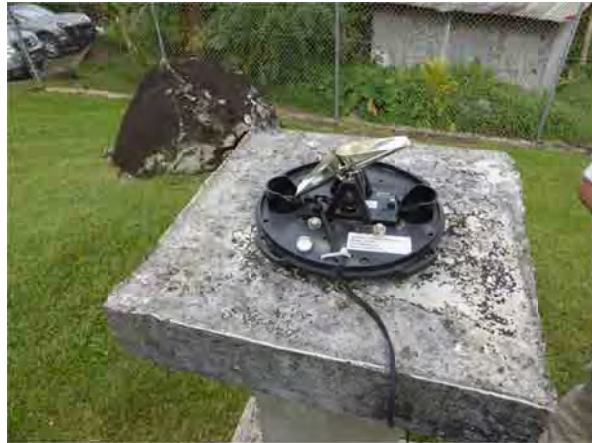
山間部に設置された雨量計（カバーをとっている）
