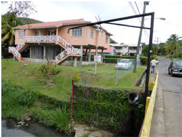
Corinth コミュニティ内の河川に設置された水位計 非接触式のため、洪水時に破壊される危険性は低い。 出典：調査団
