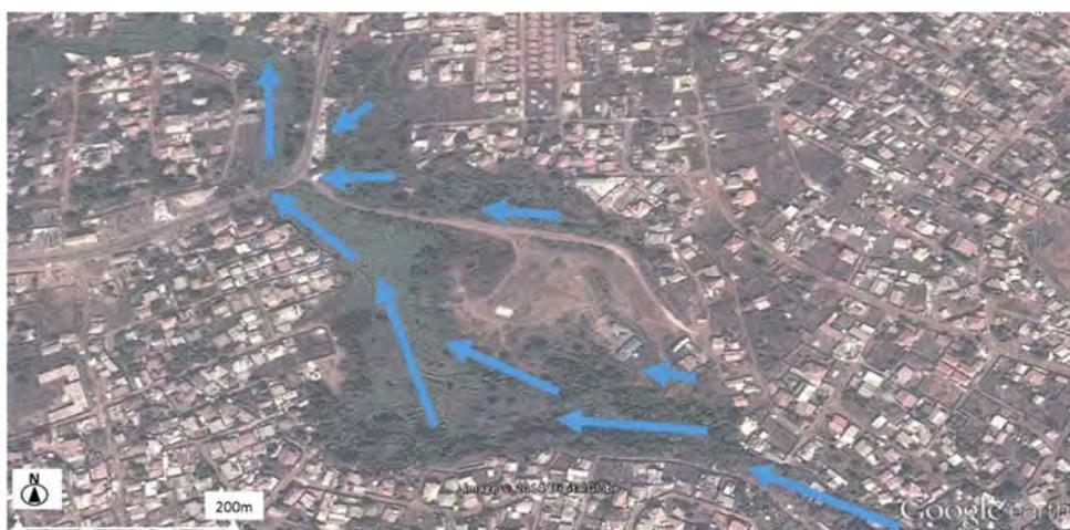
Figure A5(5)-3 Ecoulement des eaux de la zone hydraulique de Kobayah
