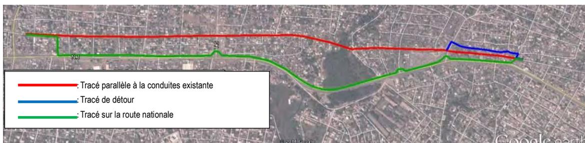
Figure 1-15 Plans alternatifs du tracé de la conduite d'eau
