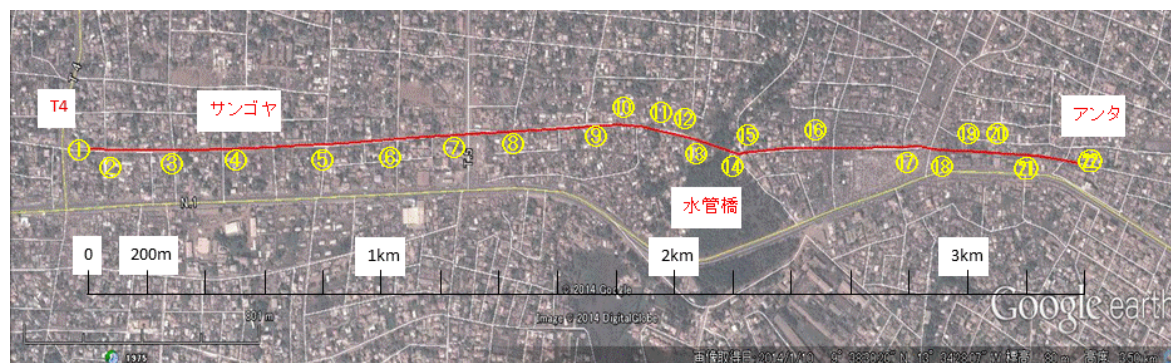
図 2-6 既存配管埋設位置調査
