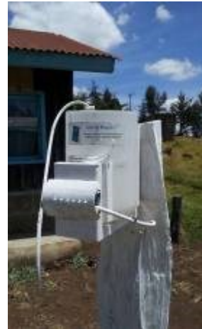
写真 4 : Ntirimiti 小学校に設置された早期警報装置付きの雨量計（パイロット事業）
