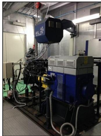
バイオ燃料の効率性を測定するためのシミュレーション機械
