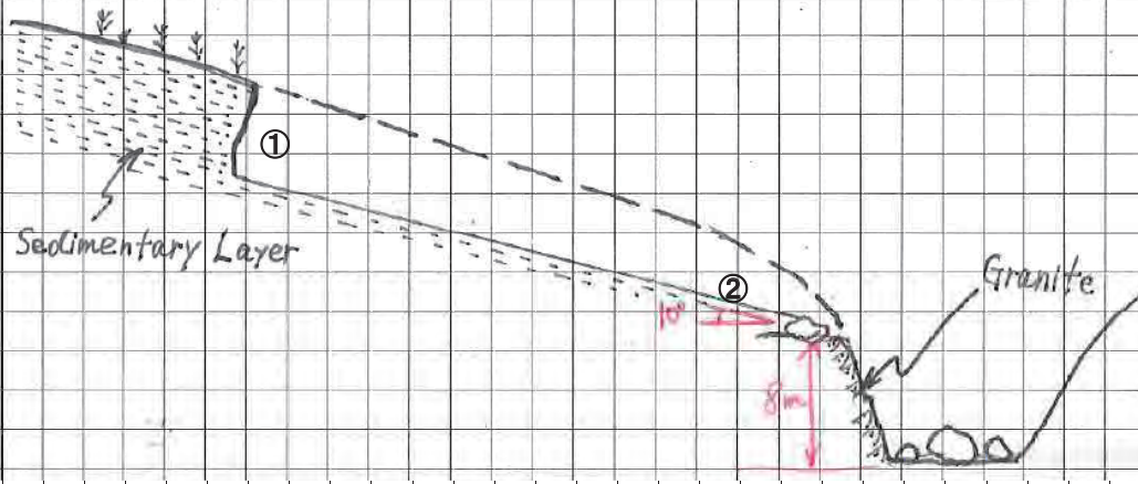
地盤侵食部分の縦断面図
