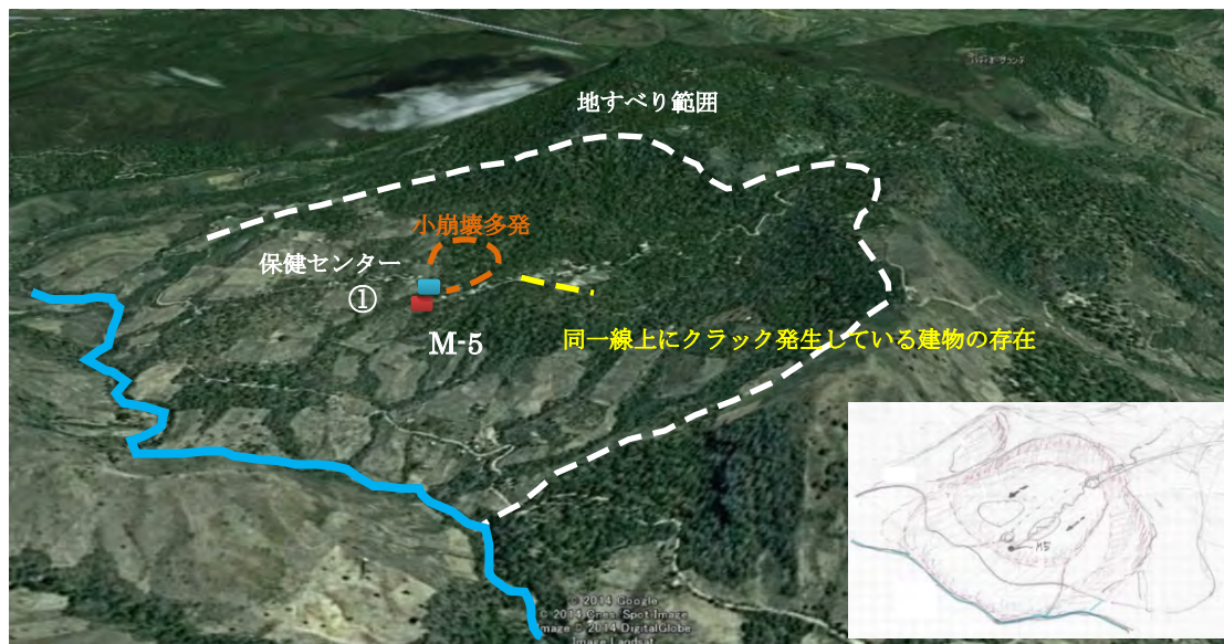
図 3-4 衛星写真による地すべり地形と学校敷地位置
