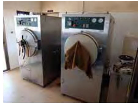
高圧蒸気滅菌器
