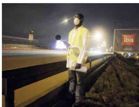
Photo 1-6 Mesures de bruit et de vibrations : la nuit
