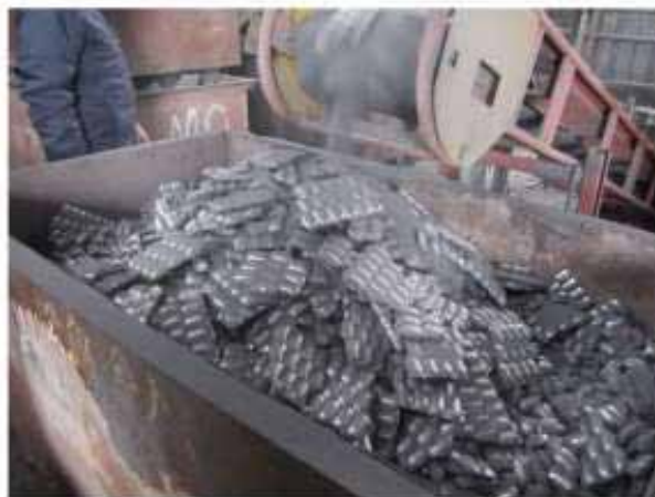
Briquette (pellet) type deoxidizer
