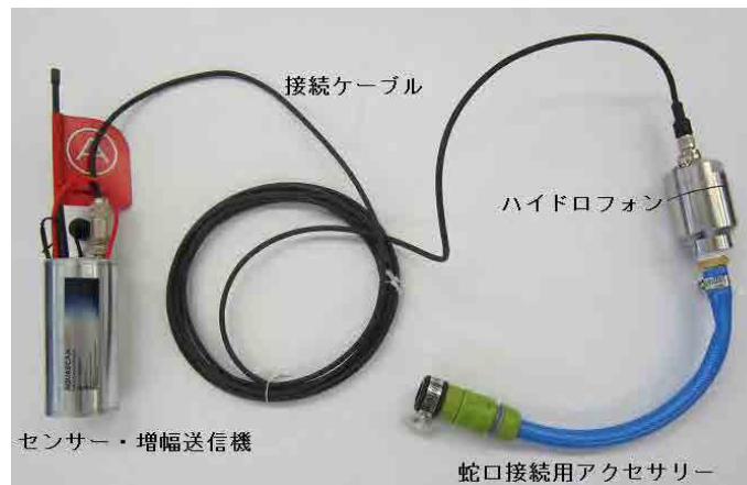
相関式漏水探知機のセンサー・増幅送信機に接続した ハイドロフォン
