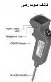
شكل 4-4 كشف التسرب باستخدام قضيب السمع أو كاشف الصوت الرقمي
