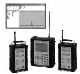
شكل رقم (4-7) جهاز كشف التسرب الترابطي
