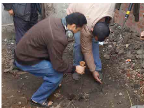
NRW県内展開活動—Kotor支所における漏水確認調査。(2013年12月)
