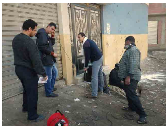
Quesna郡における漏水確認調査のためのドリル穿孔。(2013年2月)
