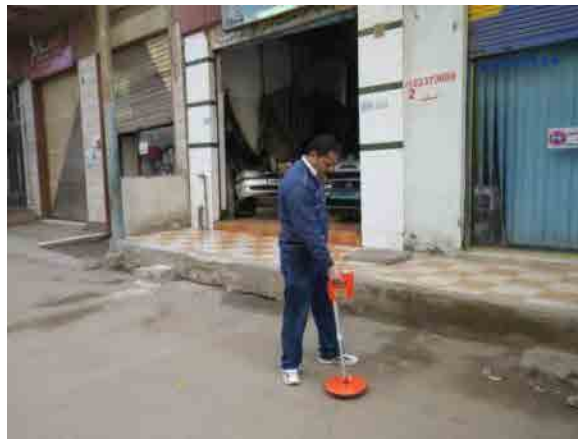
図 4.2-7 GHAPWASCO のバルブボックス位置探知訓練
