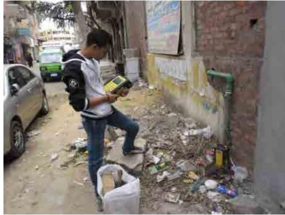
図 4.2-14 MCWW の相関式漏水調査
