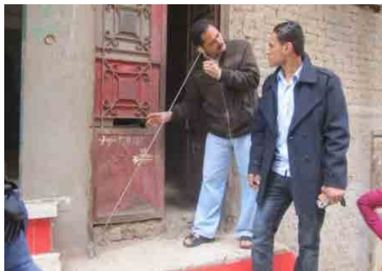
図 4.2-3 GHAPWASCO の音聴棒を使用した戸別音聴調査
