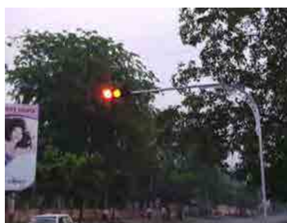
ヤンゴン市内の信号機3 赤と黄が同時に点灯し続け、故障中の信号機
