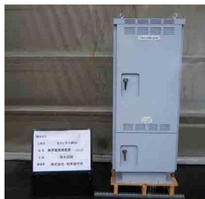
散水による防水試験：和幸製作所撮影
