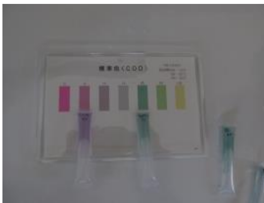
パックテストによる COD の測定
