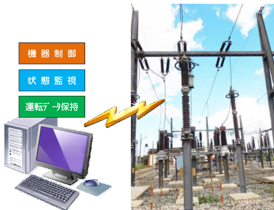
図 3-11 SCADA システム概念図
