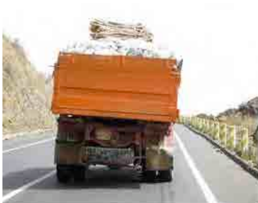
写真-10：タイヤが歪むほど石灰石を積み、走行速度が徒歩速度よりも遅い車両
