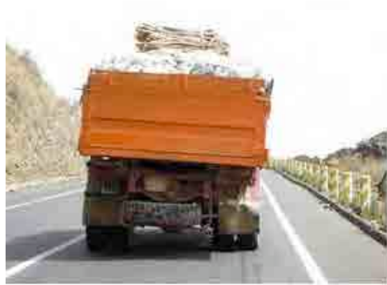
勾配が10%程度あり碎石を満載しているために速度は10km/h以下である。
