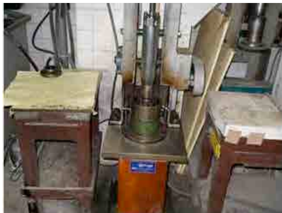
写真 マーシャルオートランマー
