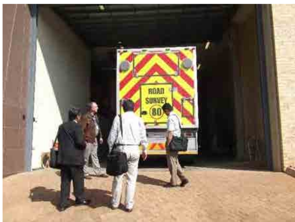
南アフリカ 80km/h で走行しながらたわみ測定を行う Traffic Speed Deflectometer (概観)
