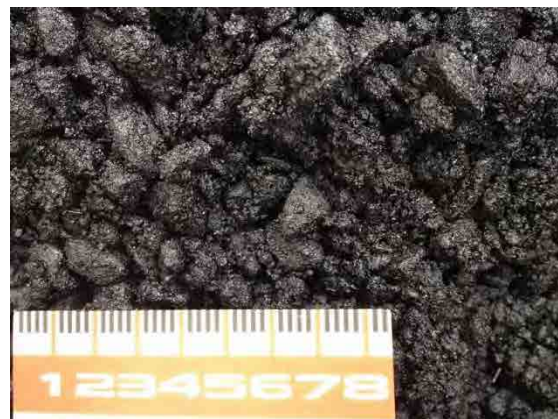
写真 4. 15 アスファルト混合物
