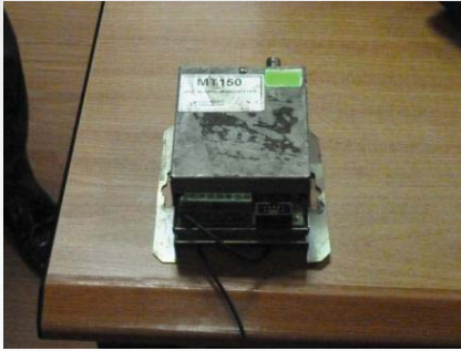
バスロケ(UB市):無線機によりバスの運行状況を管理
