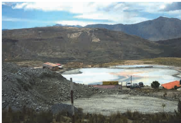
Foto 4-37 Tanque de lixiviación de empresa KH en la parte baja de planta concentradora Junji
