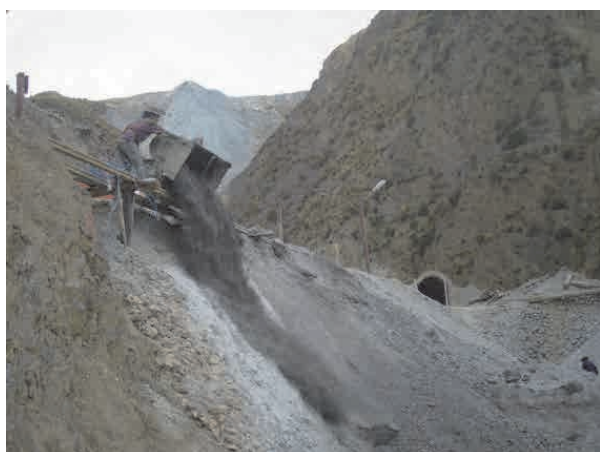
Foto 4-25 Explotación de las Cooperativas (Desmote y residuos mineros son transportados y depositados afuera de la mina)
