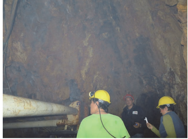
Foto 4-16 Interior mina ASM oro (veta de cuarzo minero y sistema de ventilación)
