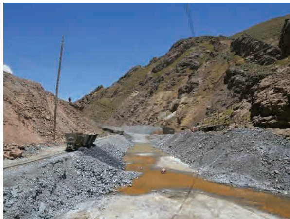
写真 5-4 坑内廃水の河川への直接排出
