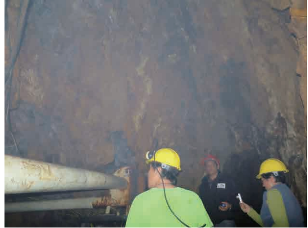
写真 5-76 金 ASM 坑内 (含金石英脈と通風管)
