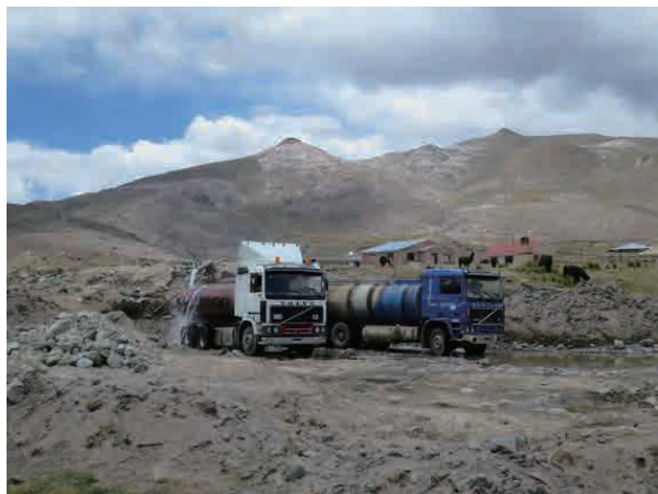
写真 5-31 サン・ローレンゾ鉱山排水の給水車への補給（セロ・リコ鉱山で利用）
