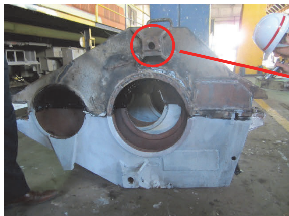
(g) 溶接による補修の状況 (全体)
