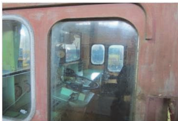
(b) 老朽化しビビ入りした押さえゴム
