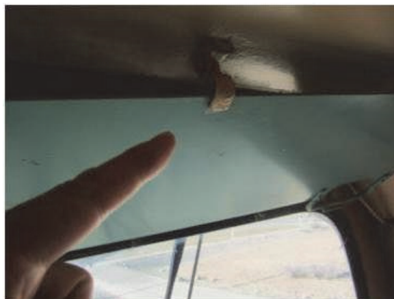
(d) 振動で外れてしまう日除け押さえ
