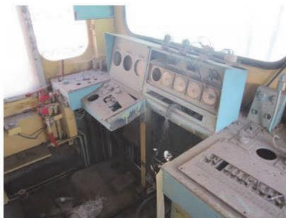
(c) 運転室 計器取り外し
