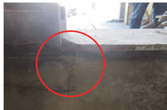
(d) 別の台車 (E1250 形式) の亀裂
