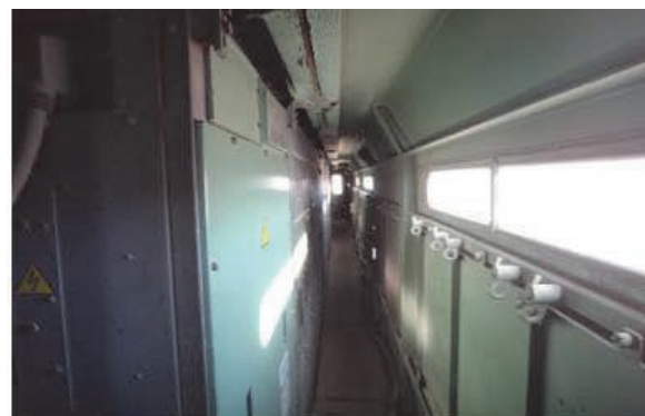
(b) Alstom 社製 SIV 床に埃が積もっている機器室環境
