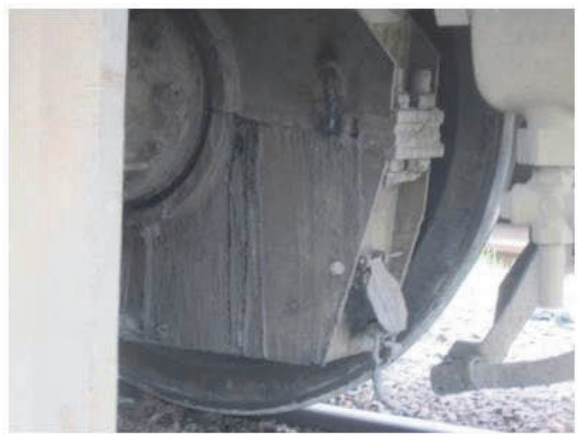
(b) ELEC 停車中の機関車 (E1117) の油漏れ
