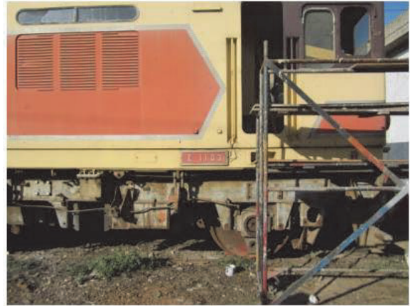
(b) 台車 主電動機取りのため軸欠落
