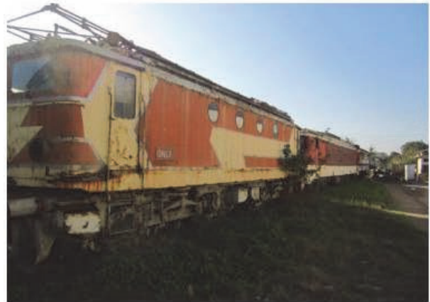
(h) 車体腐食が進んだ別形式の機関車
