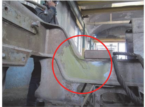
(f) 台車亀裂の溶接修繕跡
