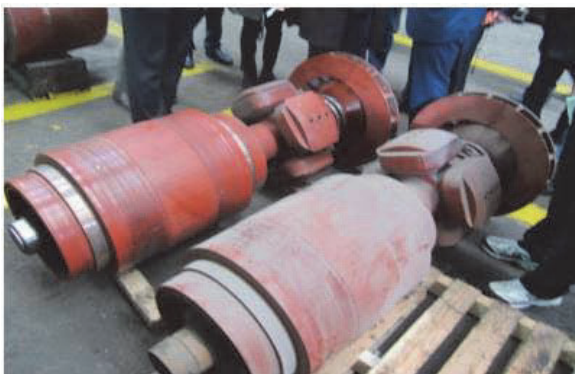
(a) 整備中の電動発電機 回転子
