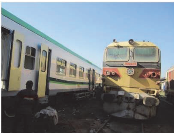
(f) E1259 SIV 故障による部品取り車
