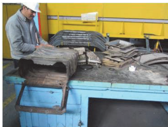
(g) 破損した風道
