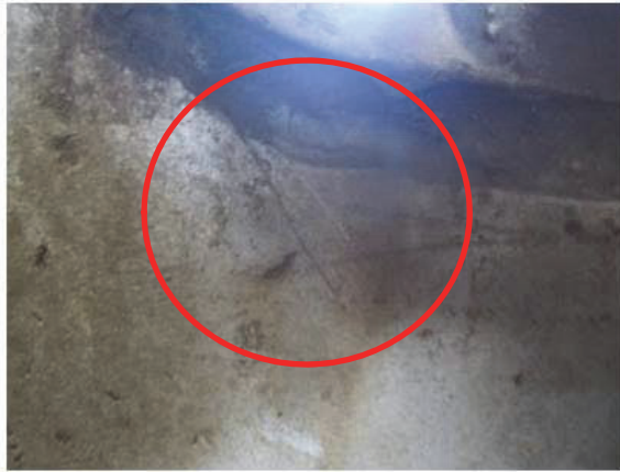
(e) 別の台車 (E1250 形式) の亀裂
