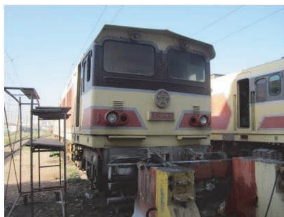
(b) E1103 架線事故による焼損にて部品取り車
