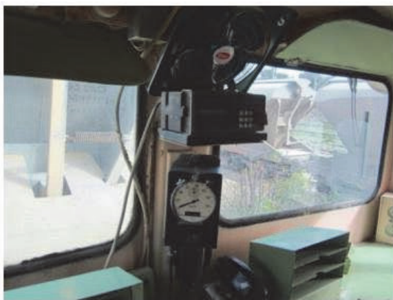
(e) 使用不能の通信装置
