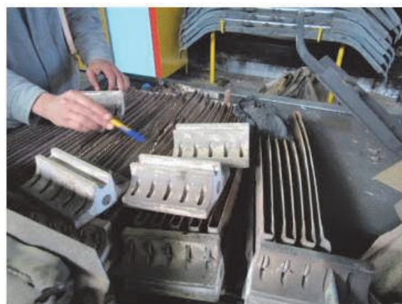
(b) 劣化した抵抗体
