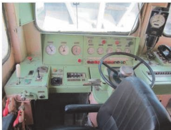
(a) 運転台全景、室内に埃侵入
