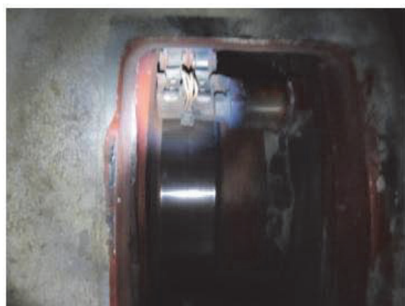
(e) 日常点検中の整流子面（良好な状態）
