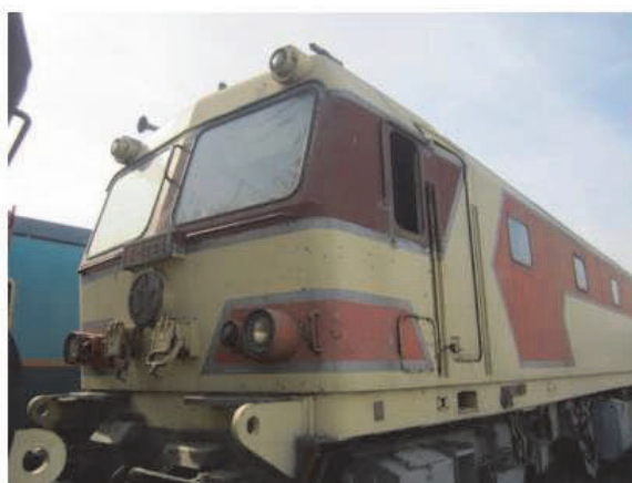
(d) E1204 主電動機、抵抗不良による部品取り車
