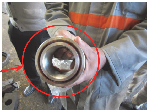
(h) 取替え修繕が多いブッシュ
