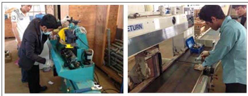
図 3-7 刃物研磨及び刃物交換実習
