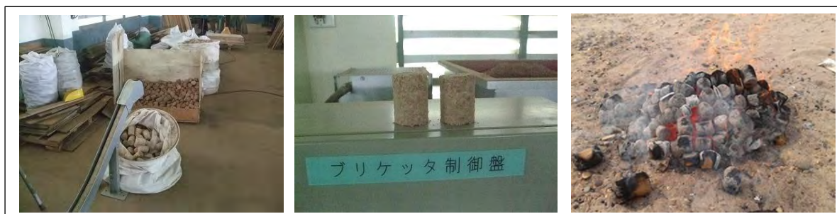
図 3-26 加工木屑の圧縮固化燃料
