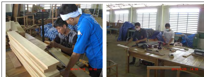
図 3-12 アリ桟、アリ桟加工（技術習得のための手作業）
