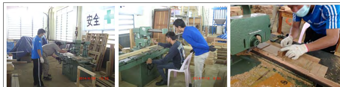
図 3-13 ラジアルソー操作指導、ラジアルソーによるアリ桟加工、検品ゲージの製作
