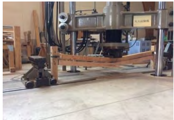
接ぎ木金物を活用したユーカリの材料強度及び構造試験
