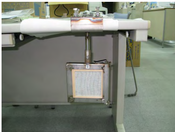
図 8.4.1 飛来塩分量計測器（ガーゼ枠）
