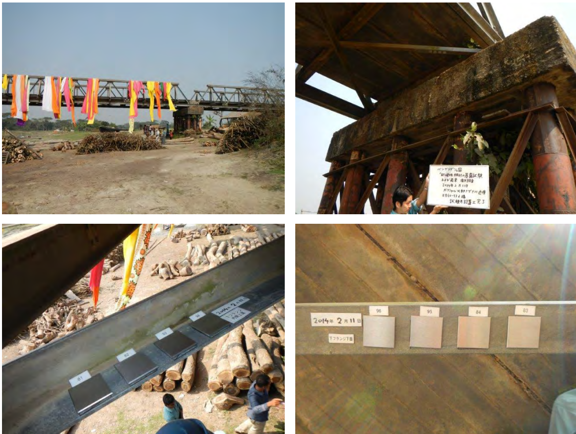
図 8.4.4 実橋梁への試験片の設置状況
