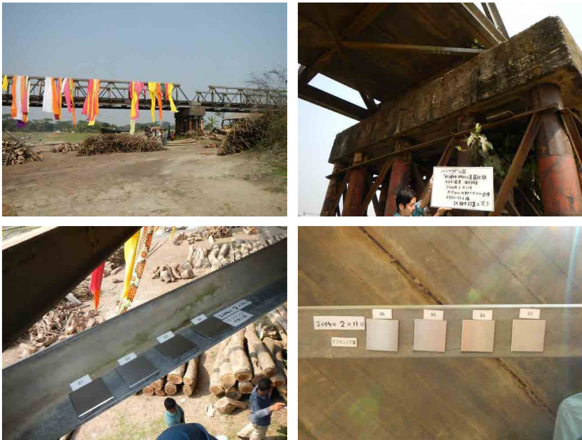
図 8.4.4 実橋梁への試験片の設置状況
