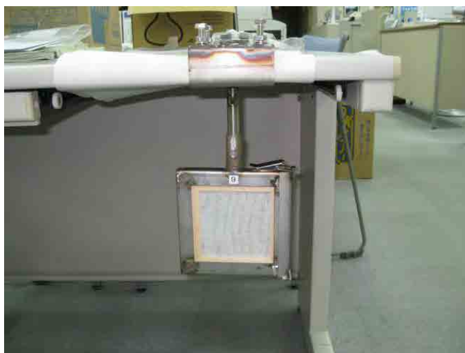
図 8.4.1 飛来塩分量計測器（ガーゼ枠）
