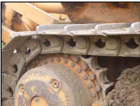
ブルドーザの足回り摩耗状況
