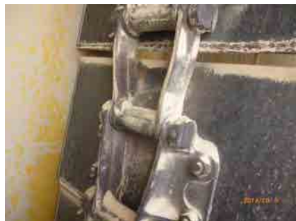
ホットエレベータのバケットチェーン(摩耗わずか)
