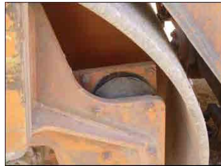
10 トン振動ローラの防振ゴムの状況
