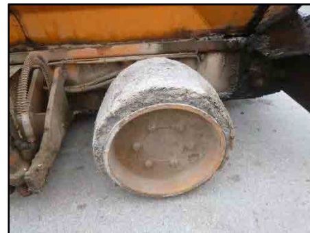
アスファルトフィニッシャの前輪摩耗状況
