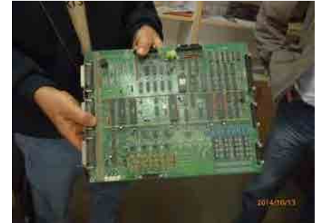
落雷被害を受けた交換した基板
