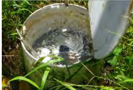
地下水が孔口から湧出している。2013年3月
