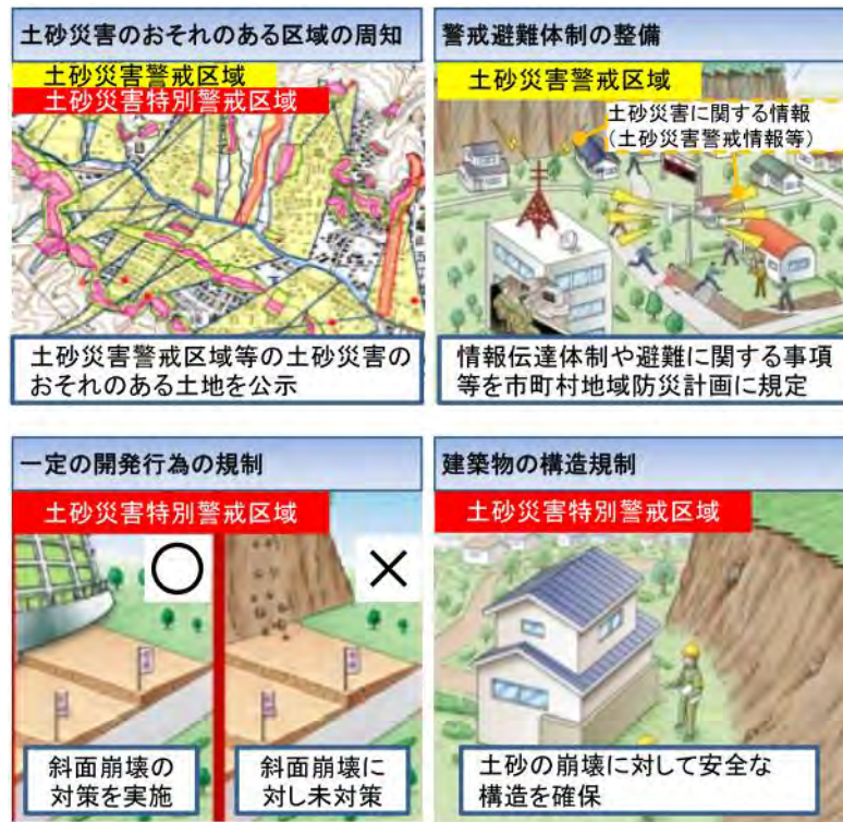
図3.10.3 土砂災害防止法制定によるソフト対策の推進のイメージ 26
