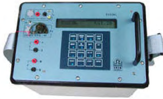
図3.5.15 SYSCAL R1 PLUS Switch-72 測定器と電極 20
