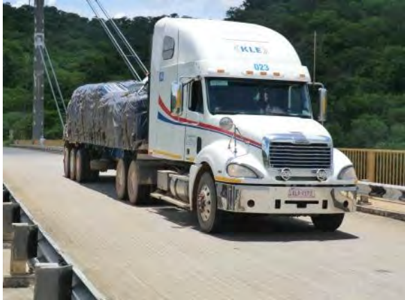
Luanguwa Br. 橋上を通過する大型トレーラー。大規模な振動が通過後も長く続いている。
