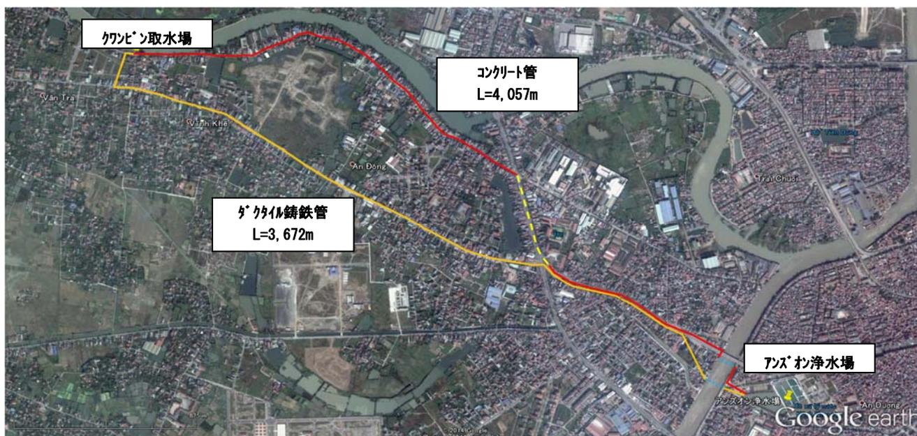
図 3-2-4 導水管経路図
