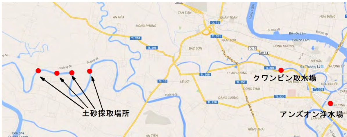
図 3-2-13 埋立工事に係る土砂採取場所
