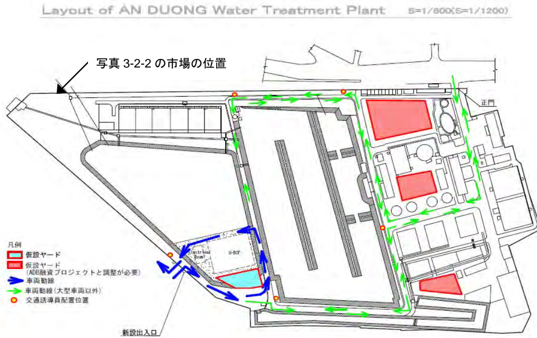
図 3-2-14 車両動線・仮設ヤード計画図
