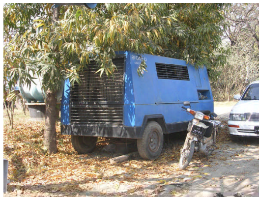
左記井戸掘削機用コンプレッサー
