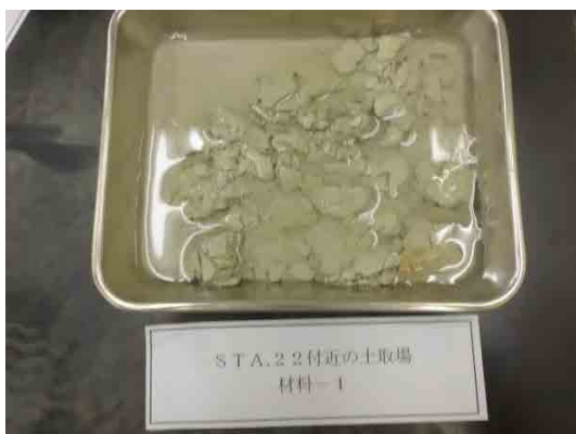
18 時間後の吸水膨張をおこし細粒化した材料-①
