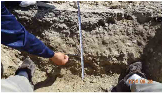
③試掘断面 (深さ 30 cm、粘性土厚さ 20 cm)
