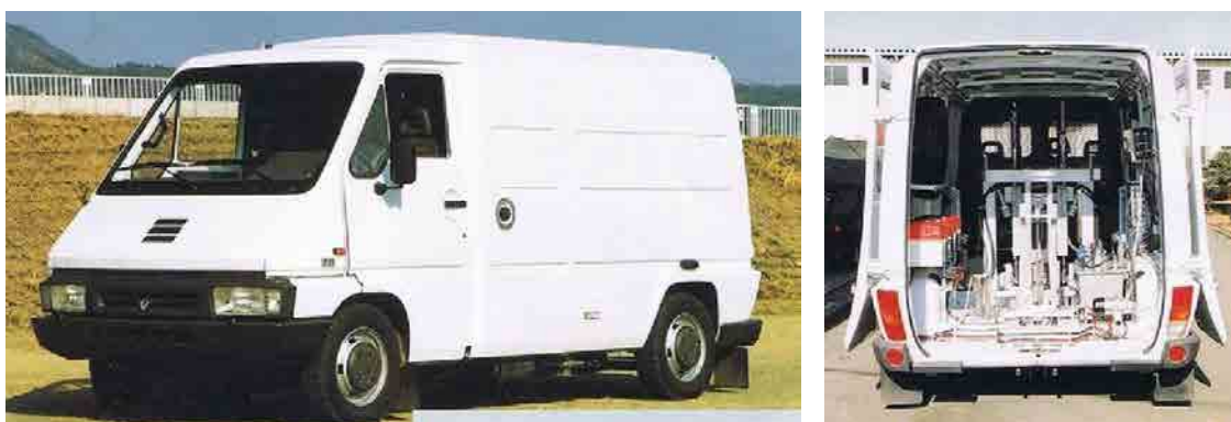
写真 1-5 車載型 FWD 測定車（例）
