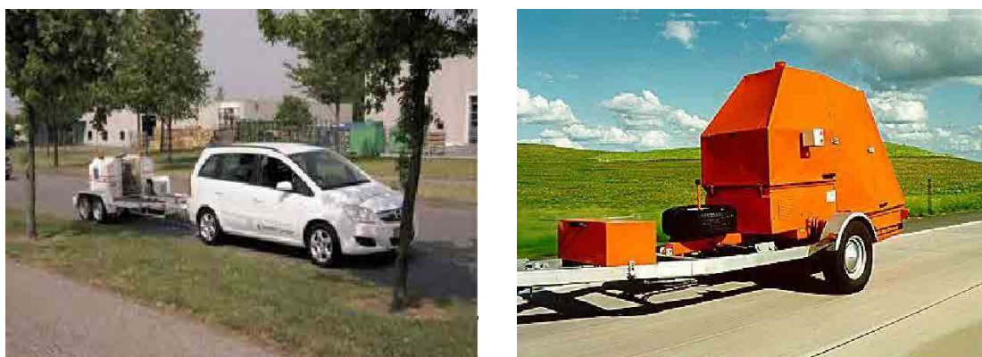
写真 1-4 牽引型 FWD 測定車（例）
