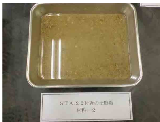
18 時間後の吸水膨張をおこし細粒化した材料-②
