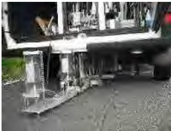
写真 1-2 たわみセンサー (例) (LVDT)
