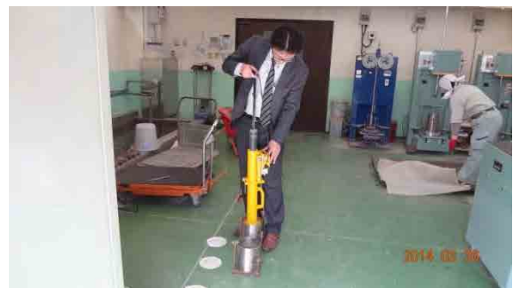
CIST による付き固めた材料を試験
