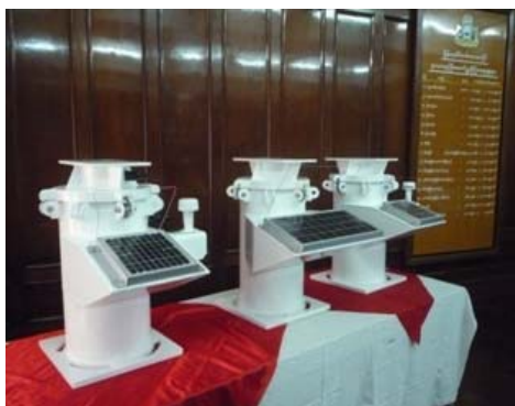
Monkey Point 用セクターライトと Thanlyin Point 用レンジライト
