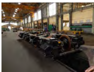
Inspection de moteur et de bogie dans la zone alternative d'inspection de locomotives
