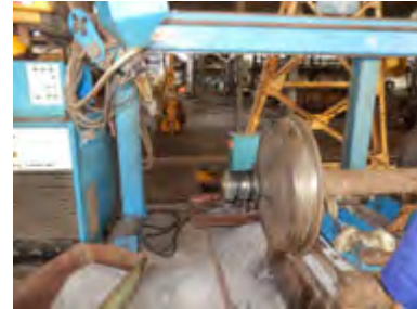
Mesure et inspection de l'usure des roues
