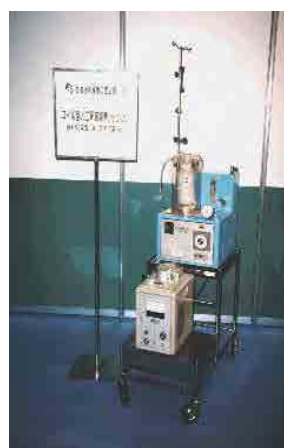
写真：コイル型ダイアライザーと呼ばれる初期型透析器（左）及びコイル型ダイアライザーを用いる血液透析装置（右）
