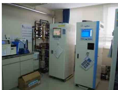
写真：多人数用透析液供給装置 (日機装) (左) 及び 透析液の清浄度を保つための UF フィルター (右)
