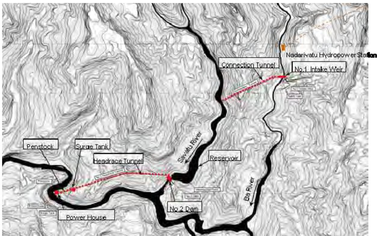
図 4.2-1 No.8 Mba 1 U/S 水力発電計画一般平面図
