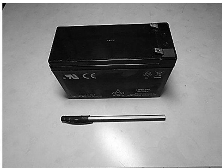
写真 9-1 片手サイズの UPS 用小型バッテリー
