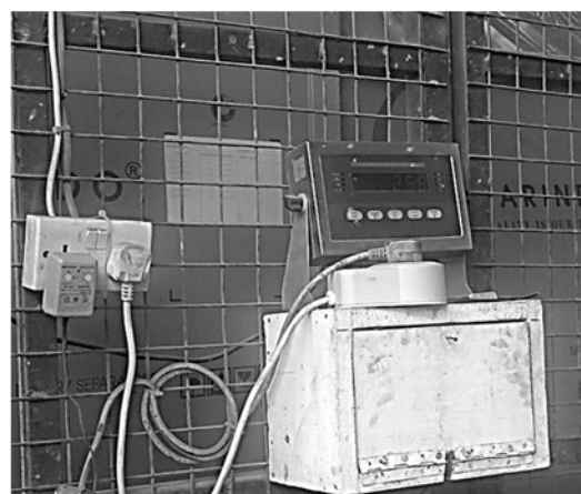
写真 6-1 ABM の台秤によるバッテリーの重量測定（左）／重量測定結果（右）
