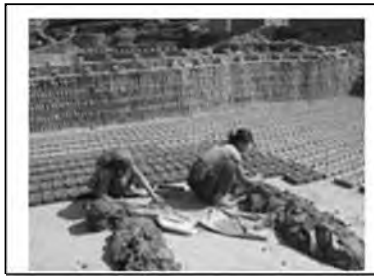
2. 生煉瓦の型枠での製作
