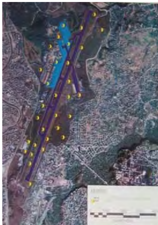
図 6－5 USAIDによる空港地盤調査の 図 6－6 液状化評価のボーリング位置 基本計画（優先順位図）
