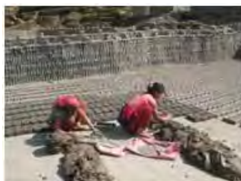
2. 生煉瓦の型枠での製作
