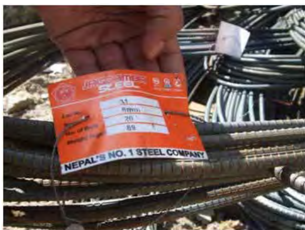
写真 5－12 ネパール製鉄筋のネパール工業規格品を示すマーク（右上の左端、17階建て住居用高層建物の建築現場で）
