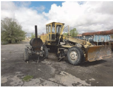
ナリン州 DEP8 (PLUAD3) モーターグレーダ (1980年ソ連製) 老朽化が激しく廃棄予定
