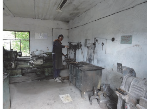
PLUAD 5 (タラス州) DEP 19 機材整備状況 ボール盤による部品製作
