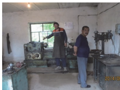
タラス州 DEP19 (PLUAD5) 旋盤、ボール盤 既存の整備機材状況
