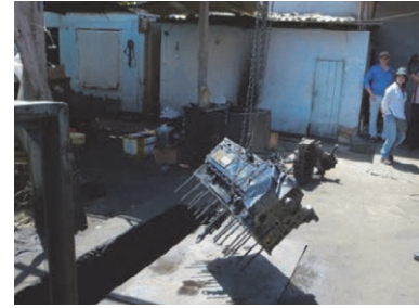
オシュ州 アクマジャノフ社 エンジン部品の交換、燃料ポンプ整備を実施している
