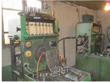
ジャララバード州 クルバノフ社 エンジン部品の交換、燃料ポンプ整備を実施している
