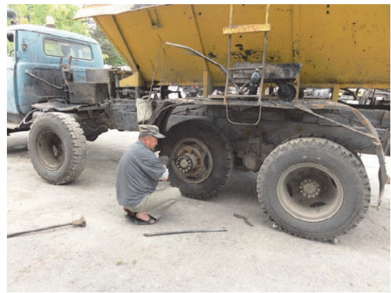
PLUAD 1 (チュイ州) DEP 958 機材整備状況 チップスプレッターのタイヤ交換
