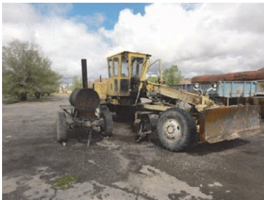
ナリン州 DEP8 (PLUAD3) モーターグレーダ (1980年ソ連製) 老朽化が激しく廃棄予定
