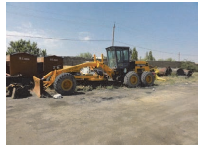
オシュ州 DEP21 (OSI UAD) モーターグレーダ (2008年中国製) エンジンが故障し修理不能
