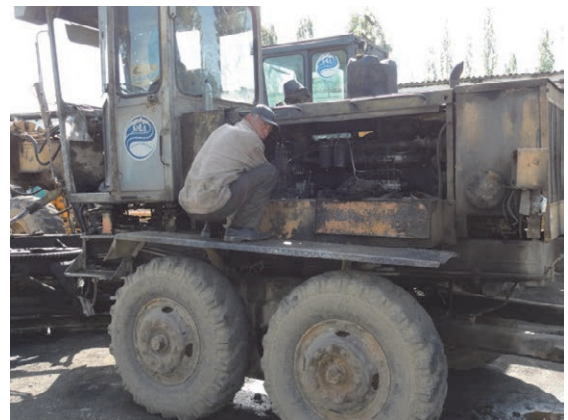
OSI UAD (ジャララバード州) DEP959 モーターグレーダ 1980年代ソ連製 エンジン修理中
