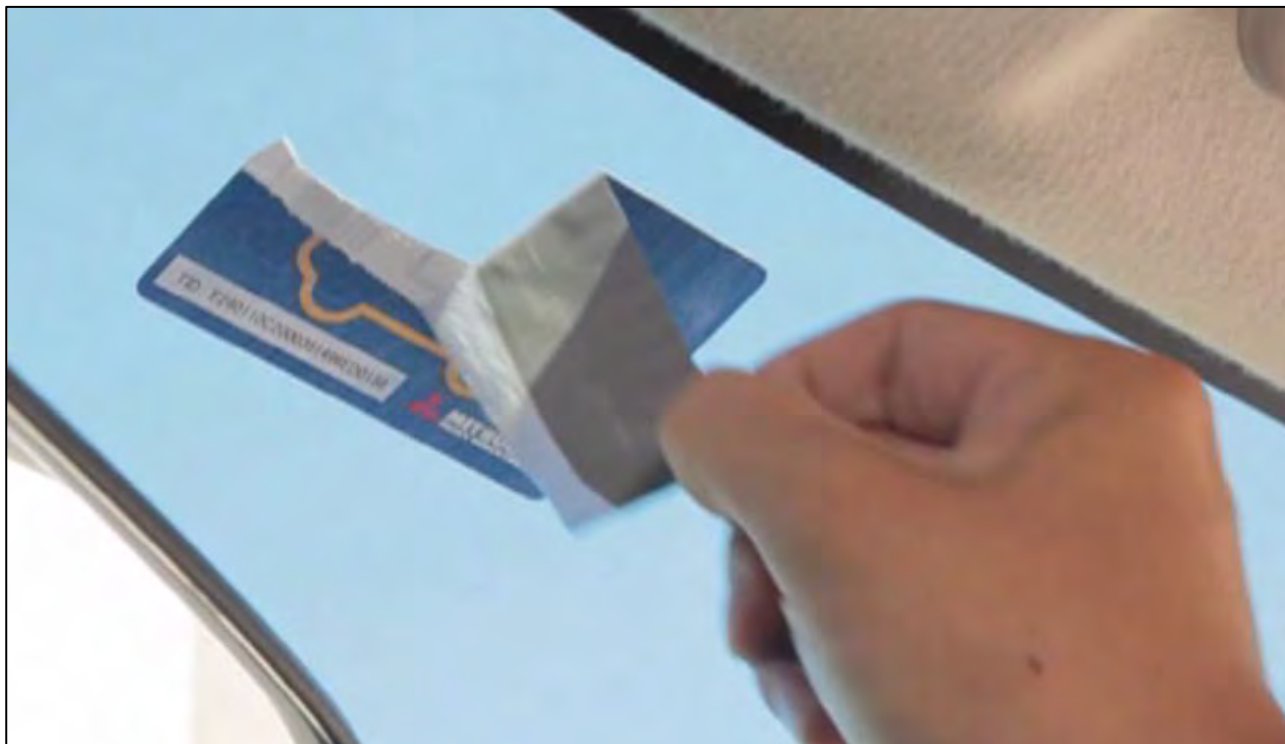
図8.3-3 RFID-Tag 張替防止機能イメージ
